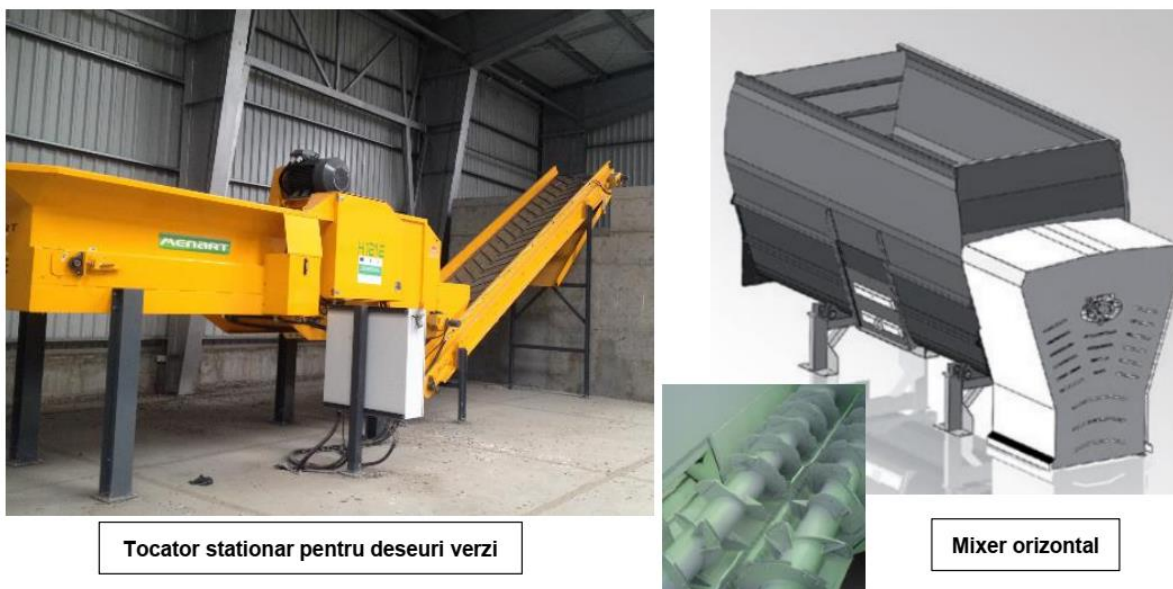
Figură 3-69 Exemple – toacător staționar de deșeuri verzi și mixer orizontal
