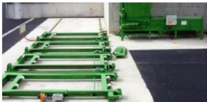
Figură 3-61 Exemplu presă fixă pentru container cu sistem automat de schimbare a containerelor
