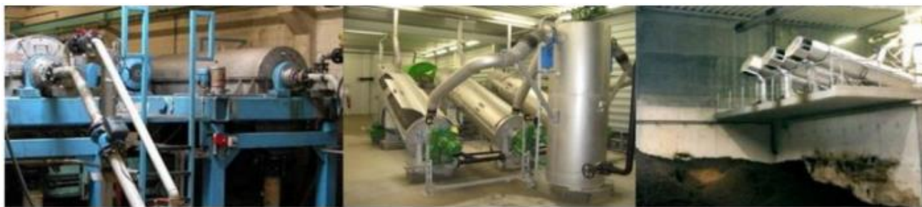
Figură 3-67 Exemplu unitate de deshidratare a digestatului
